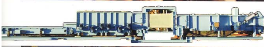
Sidoskiss över vedflödet mellan barktrumma och flishugg i Östrands renseri. Foto: Fotoworkshop
